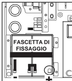
Collegare il cavo al polo positivo libero della batteria indicata in figura.
