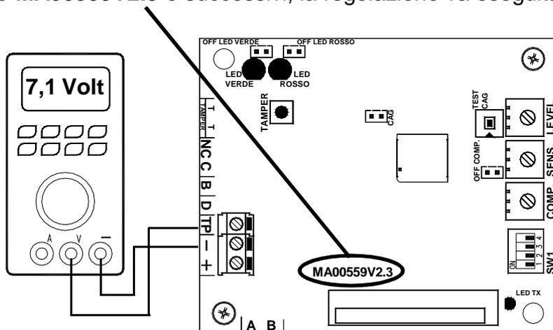
Assicurarsi di non lasciare il **trimmer LEVEL** in una posizione più elevata del necessario perché ciò porterebbe la barriera a lavorare in condizione di saturazione (troppo segnale) che si traduce in una sensibilità di rilevazione ridotta.
