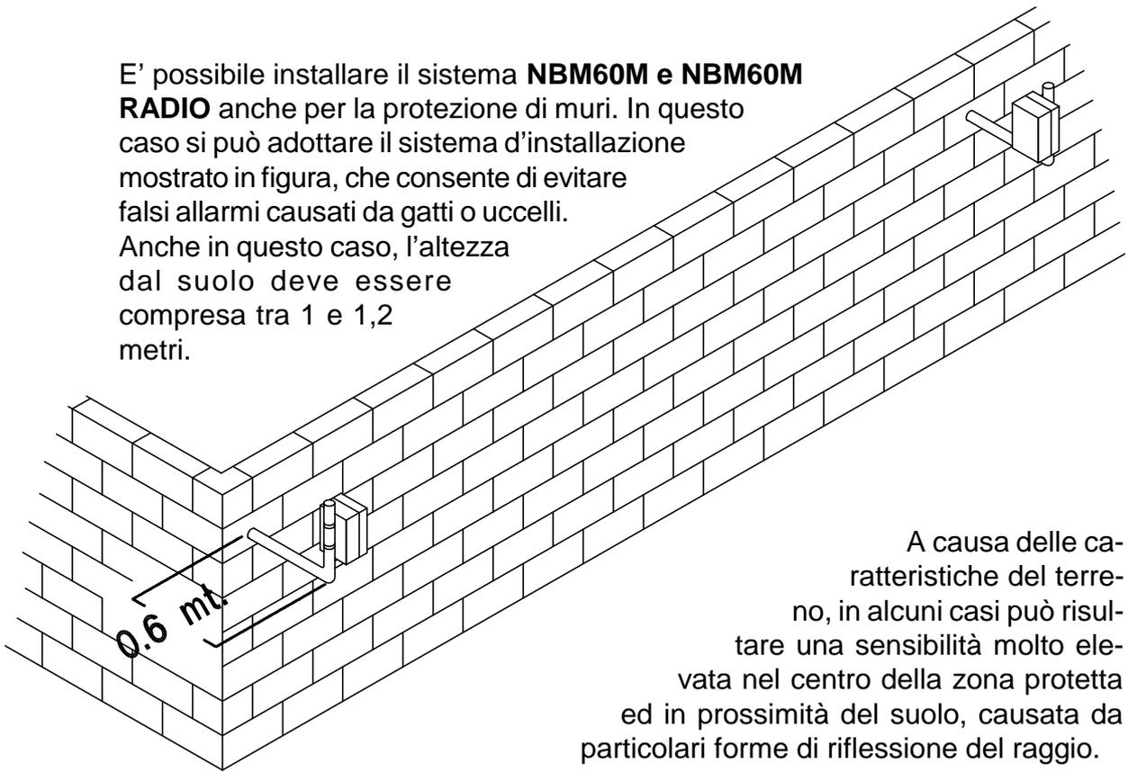
A causa delle caratteristiche del terreno, in alcuni casi può risultare una sensibilità molto elevata nel centro della zona protetta ed in prossimità del suolo, causata da particolari forme di riflessione del raggio.
