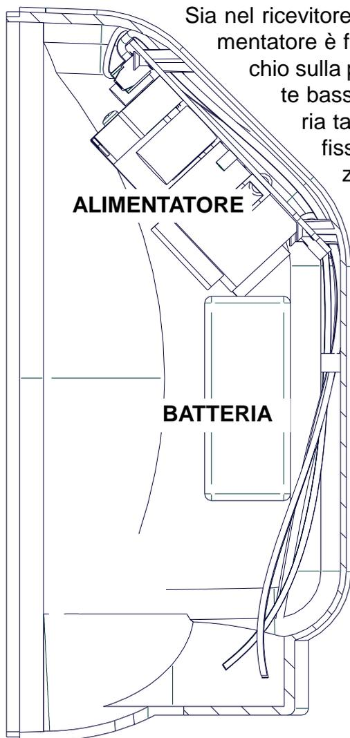
Sia nel ricevitore che nel trasmettitore, l'alimentatore è fissato all'interno del coperchio sulla parte alta, mentre sulla parte bassa viene alloggiata la batteria tampone da 12 V 0,8 Ah (da fissare con la fascetta in dotazione) che non deve superare le dimensioni di 65 mm di altezza, 96 mm di larghezza e 25 mm di profondità.
