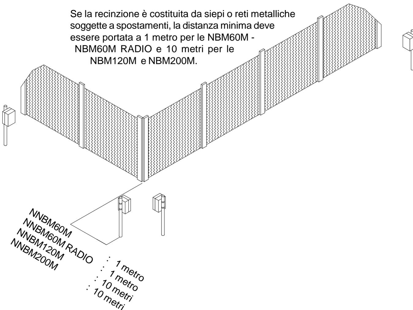
Un corridoio di larghezza non inferiore a 0,6 metri per NBM60M - NBM60M RADIO e 2 metri per NBM120M e NBM200M, deve essere lasciato libero da ostacoli per tutto il tragitto che separa il Trasmettitore dal Ricevitore; in questa zona deve essere sempre garantita una chiara linea di vista.
