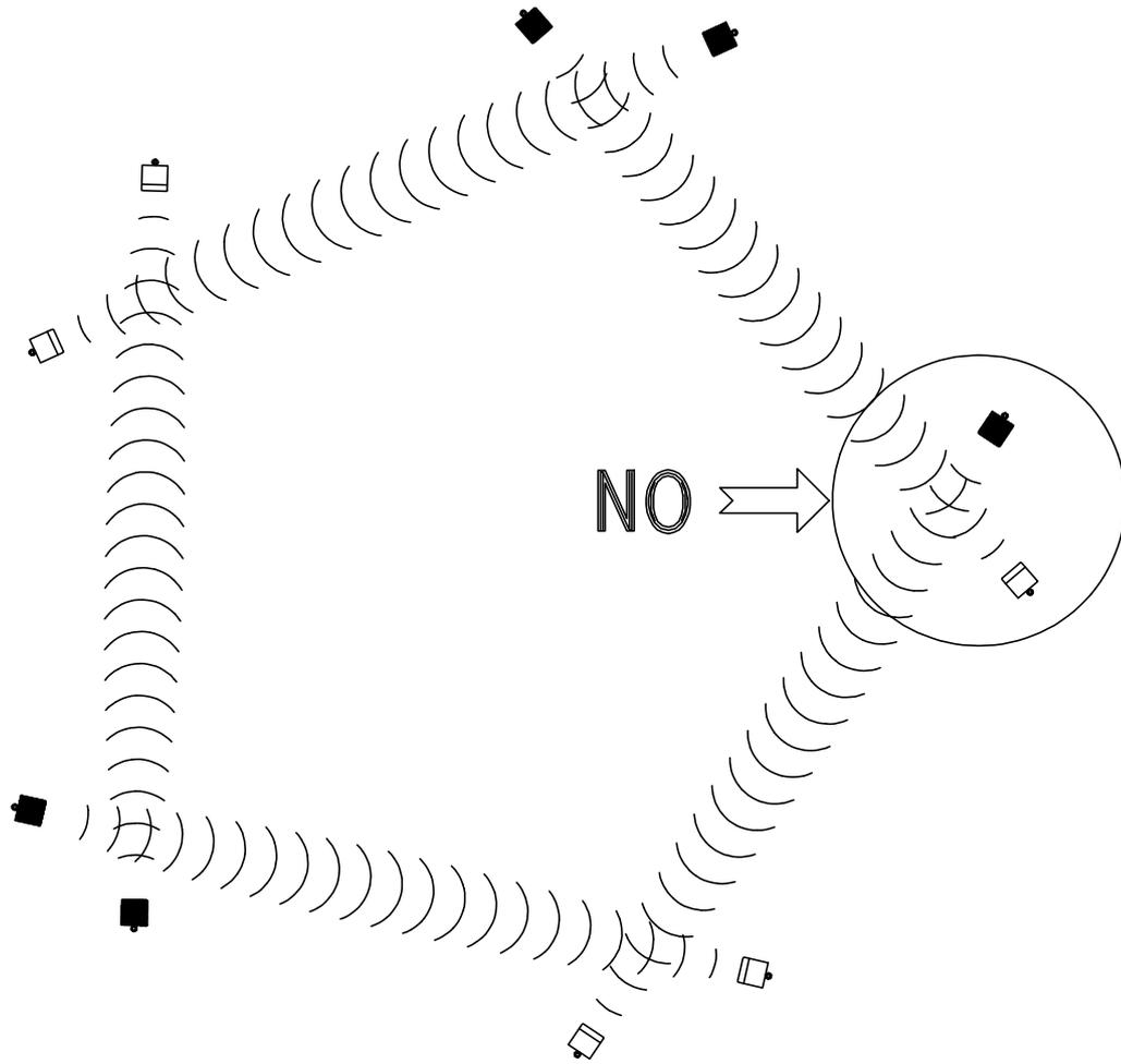
Si deve assolutamente evitare di installare un Trasmettitore nelle vicinanze di un Ricevitore appartenente ad un'altra coppia.
