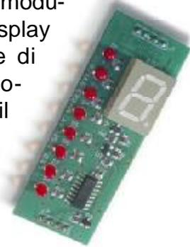
Questo sistema di remotizzazione dei livelli di segnale delle barriere è composto da un modulo a led / display (**NLCD W**), per ogni coppia di barriere, da inserire nel contenitore **NBR100**. Grazie a a questo sistema è possibile monitorare costantemente **da 1 a 4 coppie** di NBM M.
