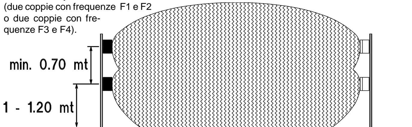
Se la recinzione è costituita da siepi o reti metalliche soggette a spostamenti, la distanza minima deve essere portata a 1 metro per le NBM60M - NBM60M RADIO e 10 metri per le NBM120M e NBM200M.
